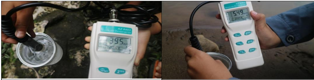
d. Pengukuran Oksigen Terlarut dan Suhu
