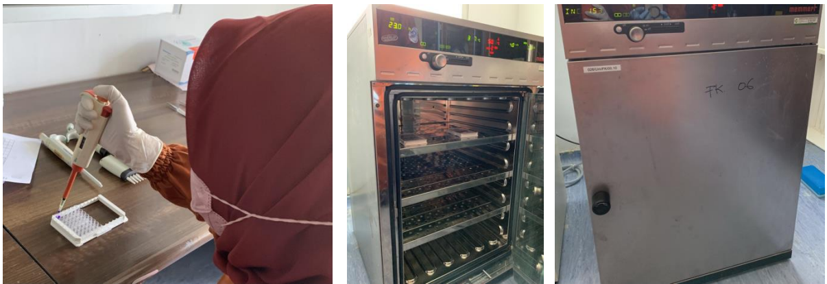
Gambar 14. Pewarnaan dengan crystal violet , inkubasi pada suhu 37°C selama 30 menit pada suasana gelap didalam incubator
