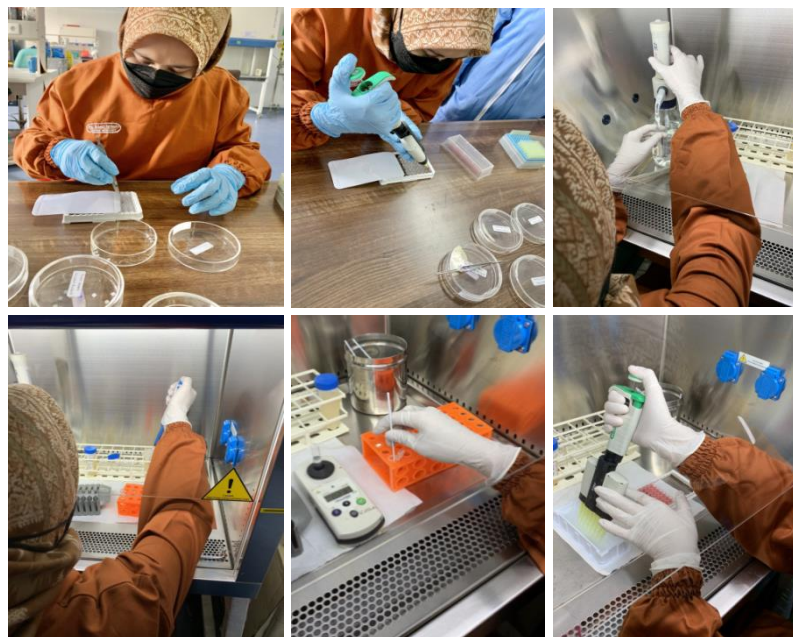
Gambar 12. Memasukkan braket- archwire masing-masing kelompok kedalam microplate , kemudian menambahkan saliva buatan, sukrosa, isolat Lactobacillus Acidophilus .
