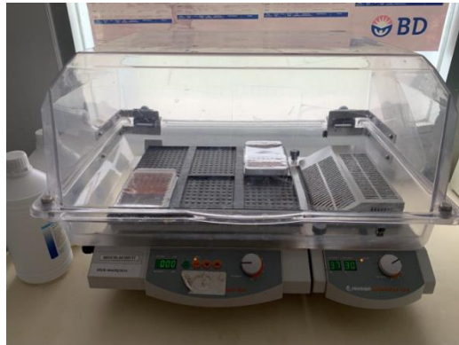
Gambar 13. Inkubasi microplate yang telah berisi sampel dalam suhu 37°C selama 24 jam, dishake sebesar 150 rpm
