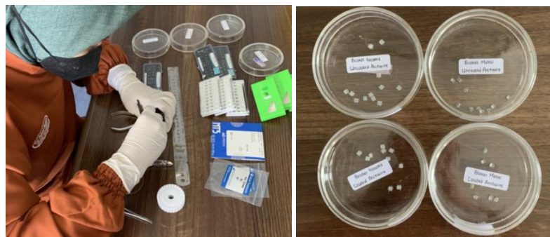
Gambar 11. Pemotongan Coated dan uncoated NiTi archwire dengan ukuran yang sama, Archwire dimasukkan ke slot braket sesuai dengan kelompok yang telah ditentukan dan diligasi dengan ligature wire dengan 3 ulir
