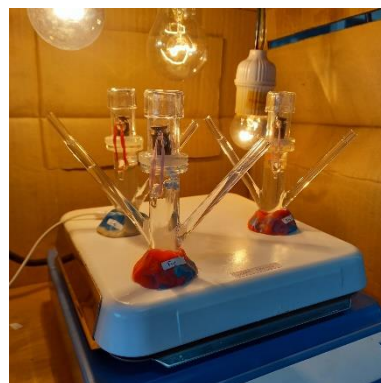
Gambar 21. Uji permeasi ex vivo dengan alat-alat yang dimodifikasi
