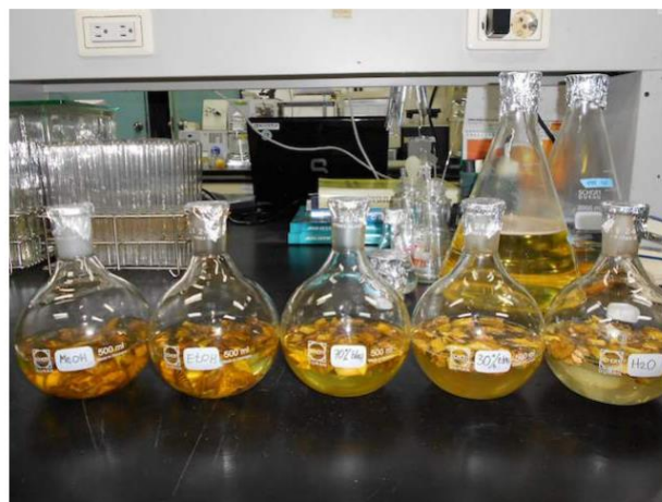
Gambar 2. Metode maserasi skala kecil (Nugroho, 2017)
