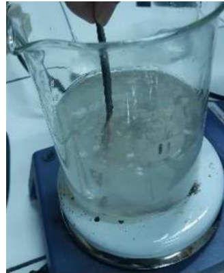
Gambar 9. Pembuatan larutan koloidal natrium CMC 0,5%
