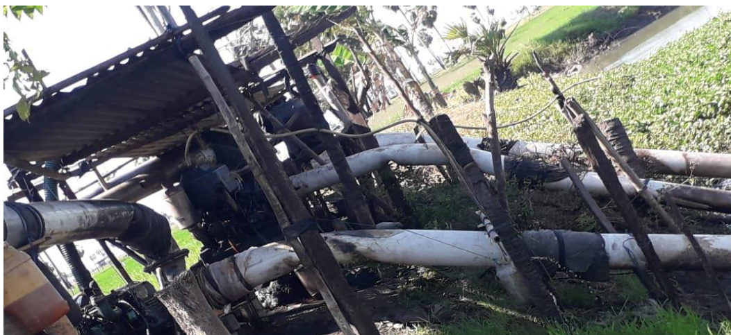
Dokumentasi. Mesin Pompa yang Memperoleh Air dari Penampungan Sementara yang Kemudian Diteruskan Ke Parit Areal Sawah.
