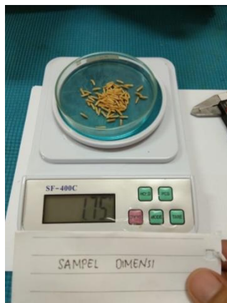
Gambar 18. Penimbangan sampel untuk pengukuran dimensi 100 butir (a); Pengukuran dimensi gabah padi lokal varietas siam mutiara (b);
