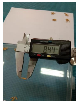
Gambar 18. Penimbangan sampel untuk pengukuran dimensi 100 butir (a); Pengukuran dimensi gabah padi lokal varietas siam mutiara (b);
