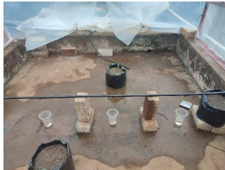
(b) Mengukur keseragaman debit irigasi
