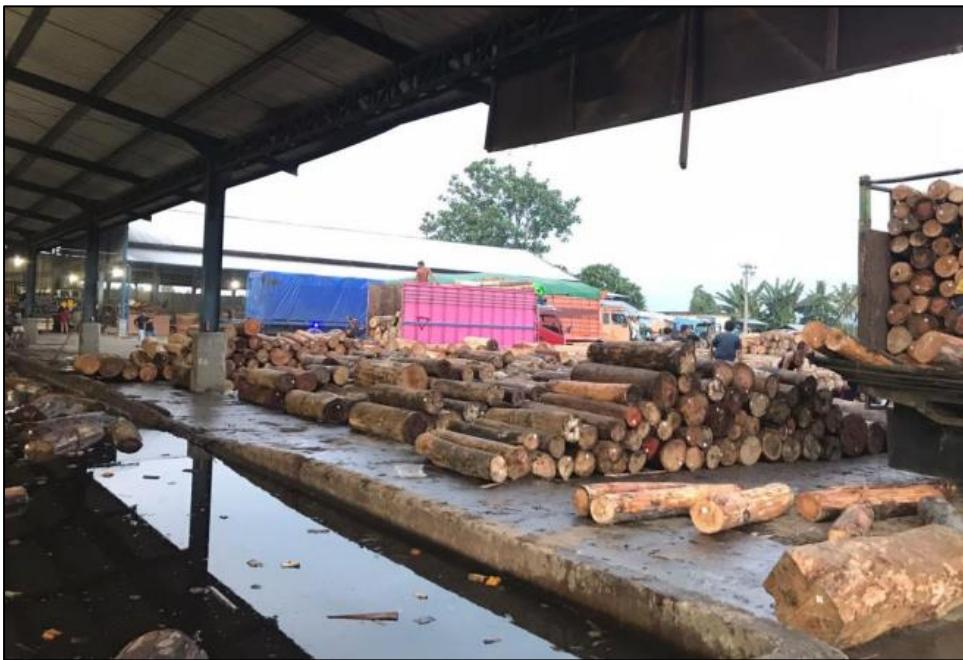
Gambar 2. Proses perendaman bahan baku di log pond
