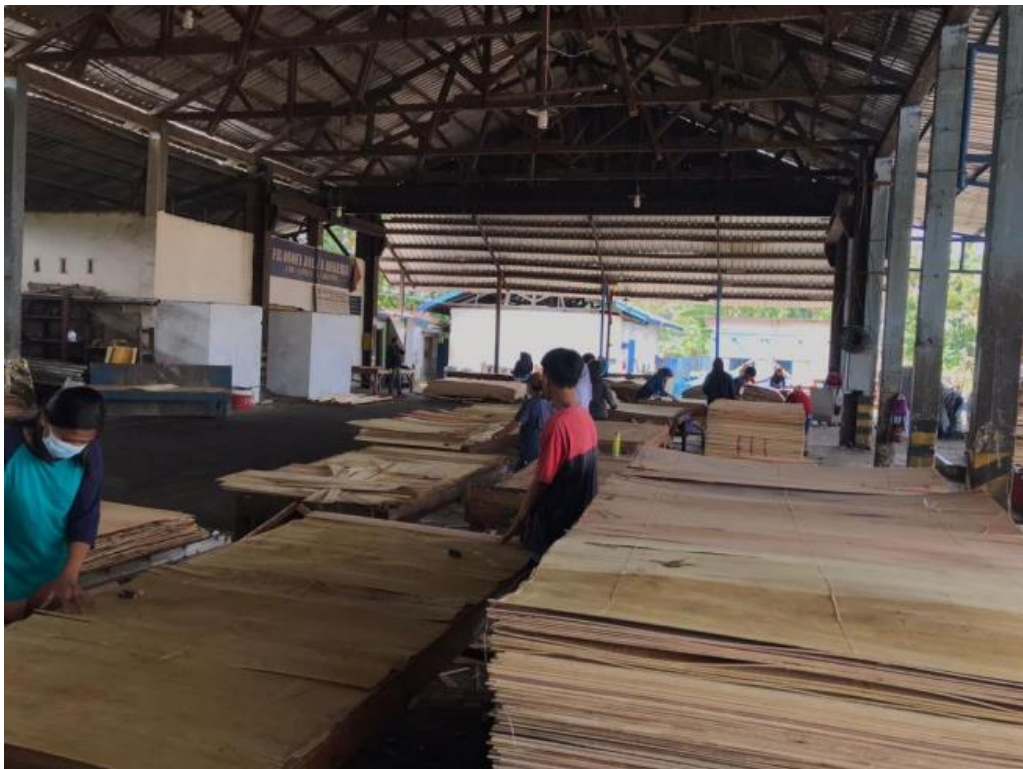
Gambar 4. Proses penyusunan lembaran veneer
