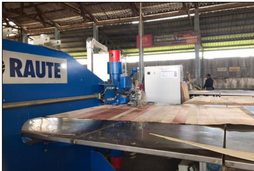
Gambar 3. Proses pengupasan log menjadi lembaran vener
