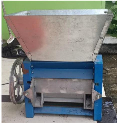
Gambar 5. Alat Pengupas Kulit Kopi Tipe Basah (*Pulper*).
