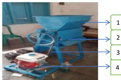
Gambar 1. Mesin pengupas kulit kopi basah menggunakan tenaga penggerak motor bakar
