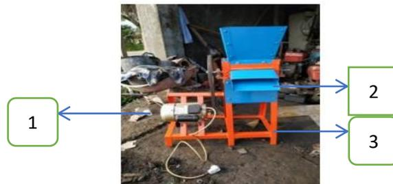
Gambar 2. Mesin pengupas kulit kopi basah menggunakan tenaga penggerak motor Listrik
