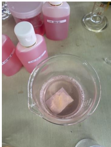
Gambar 13. Kain saring yang telah diolesi margarin dimasukkan kedalam larutan sediaan sabun cair
