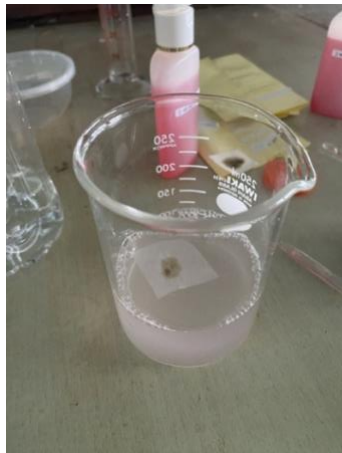
Gambar 11. Kertas saring yang telah ditetesi oli bekas dimasukkan dalam larutan sediaan sabun cair
