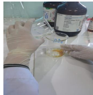
Sampel dimaserasi aseton hingga 25 mL
