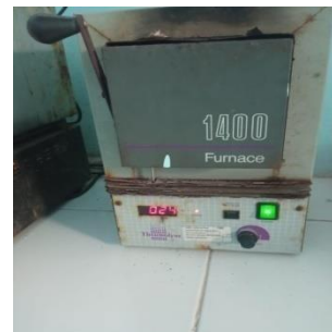
Sampel ditanur selama \pm 3 jam pada suhu \pm 600^{\circ}\text{C}
