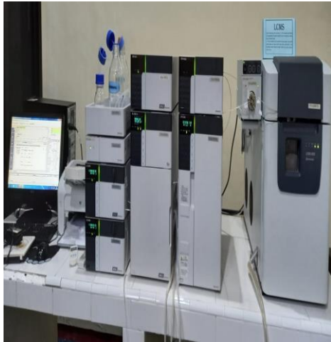
Proses pengujian sampel kopi pada alat LCMS
