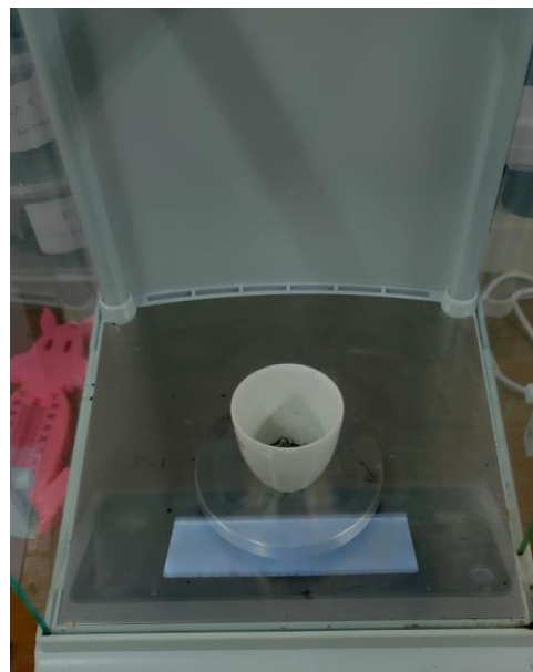
Pengovenan dan menimbang berat sampel biji kopi setelah di oven
