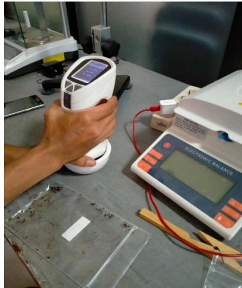
Pengukuran warna menggunakan colorimeter model CS-10
