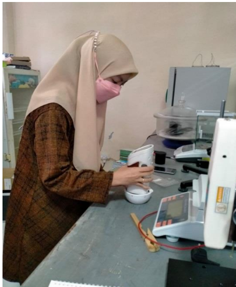
Pengukuran warna menggunakan colorimeter model CS-10
