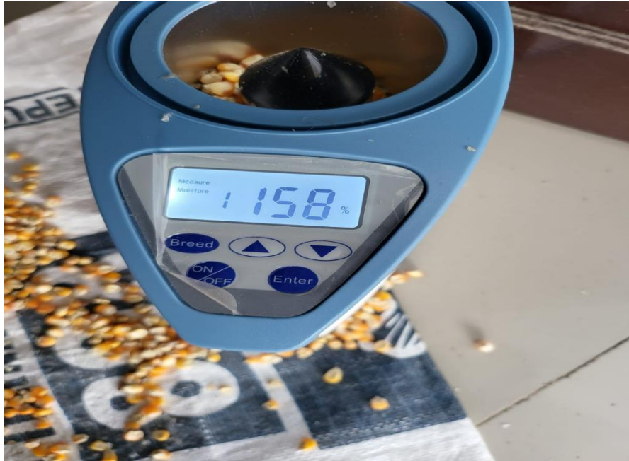
Gambar 5 : Pengukuran Kadar Air Jagung Menggunakan Moisture Meter
