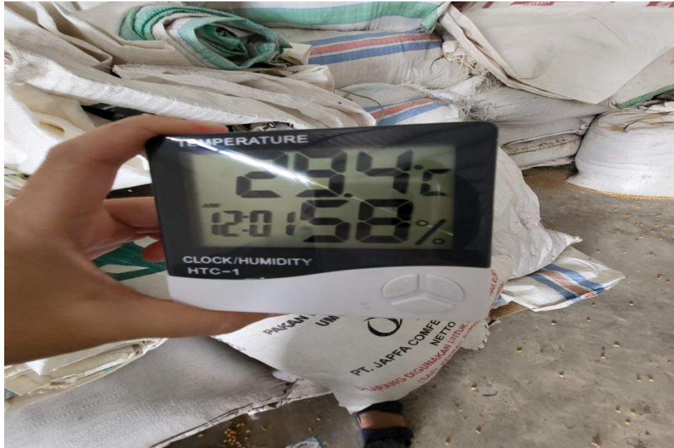
Gambar 7 : Pengukuran Suhu Lingkungan menggunakan Termometer Digital
