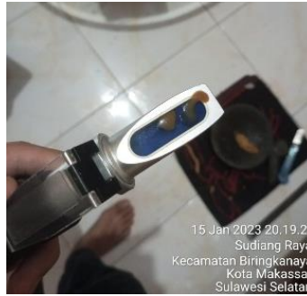
Gambar Lampiran 3. Pengukuran kadar gula pada umbi menggunakan refraktometer.
