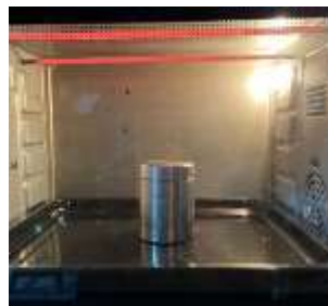
Proses Hidrotermal Residu Teh
