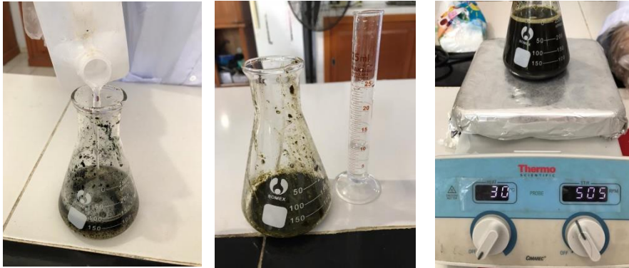
Gambar 24. Pencampuran dengan larutan methanol selama 3 jam, lalu di stir (aduk) selama 6 jam.
