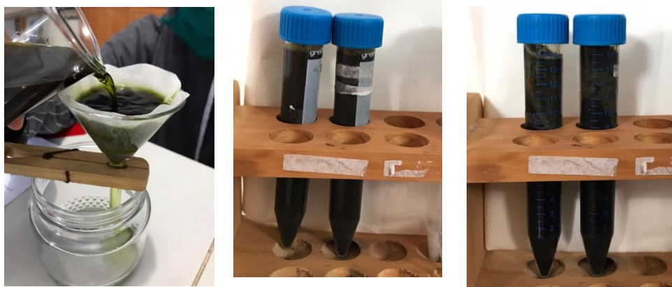
Gambar 25. Penyaringan filtrate dilanjutkan dengan teknik sentrifugasi.
