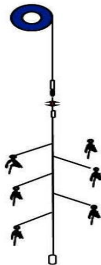
Gambar 1. Konstruksi sederhana pancing tegak Sumber: Yahya & Rahmat (2017)
