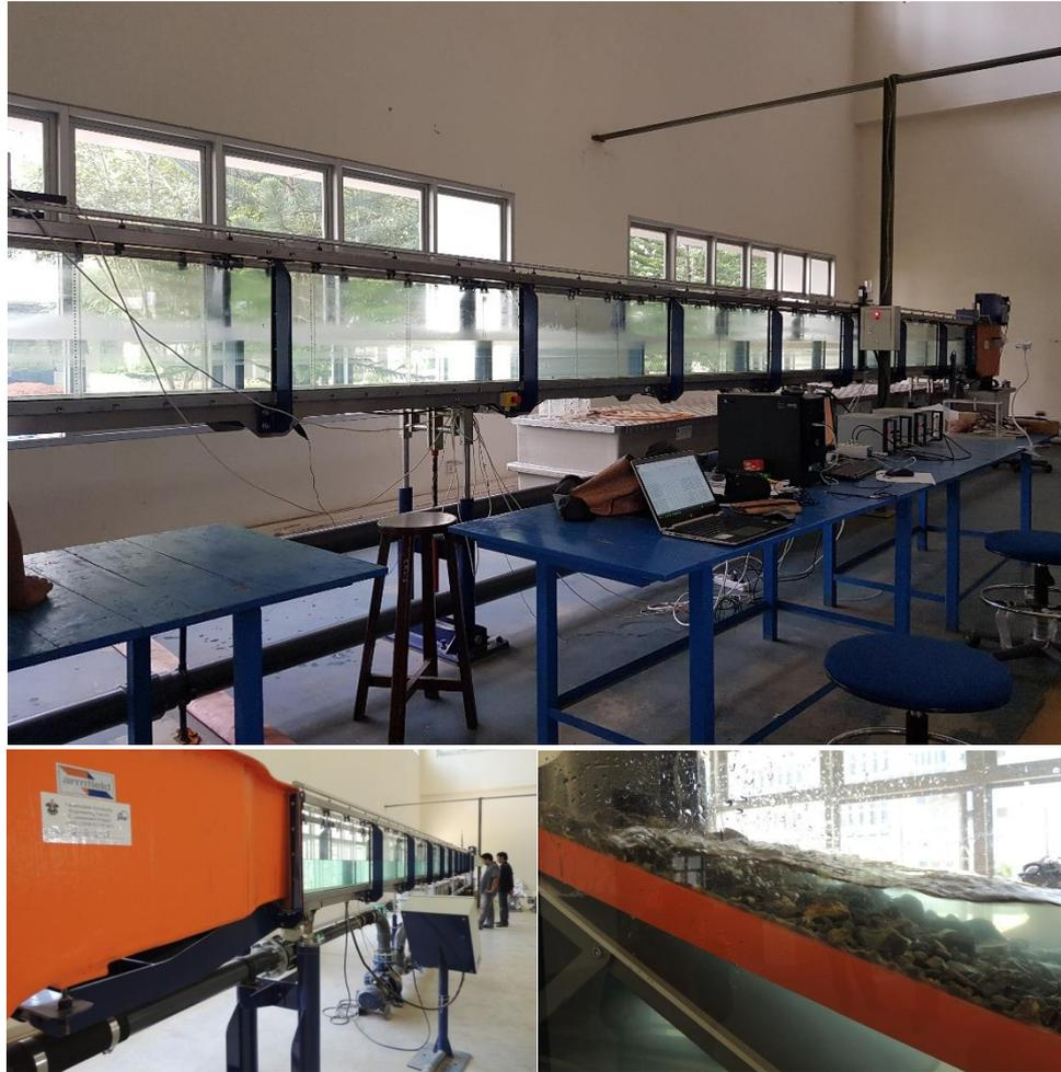
Gambar 37. *Wave flume* yang digunakan untuk uji model
