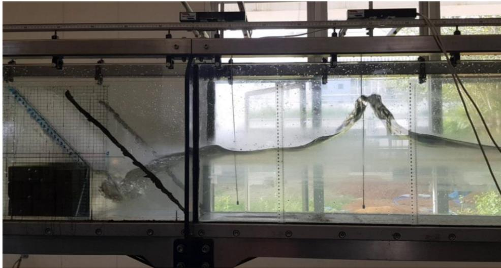
Gambar 56. Fenomena gelombang berdiri yang terjadi pada penelitian **3. Pengaruh *Reflection Coefficient* ( $K_r$ ) terhadap *run-up relative* ( $R_u/H_i$ )**
