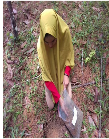
Penggalian lubang untuk kedalaman tanah diluar plot dan pengambilan sampel tanah
