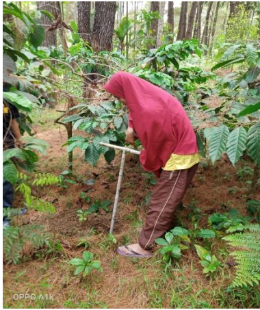
Penggalian lubang untuk kedalaman tanah diluar plot dan pengambilan sampel tanah
