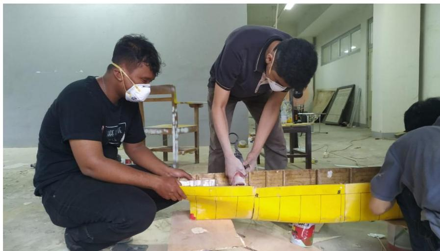
Gambar 21. Proses pemotongan lambung kapal menjadi 5 kompartemen
