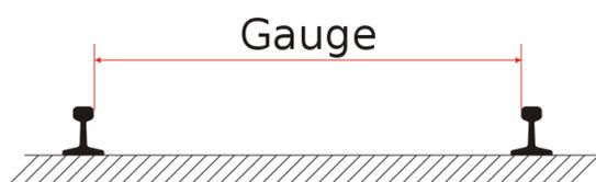
Gambar 2.1 Perhitungan jarak lebar jalur kereta api atau lebar sepur.
