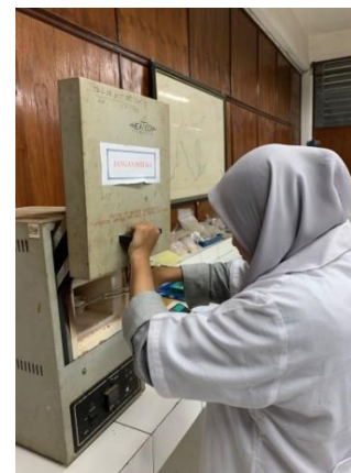
Memasukkan sampel sedimen ke dalam tanur
