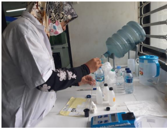
Gambar 23. Pengukuran kekeruhan menggunakan turbidimeter di laboratorium
