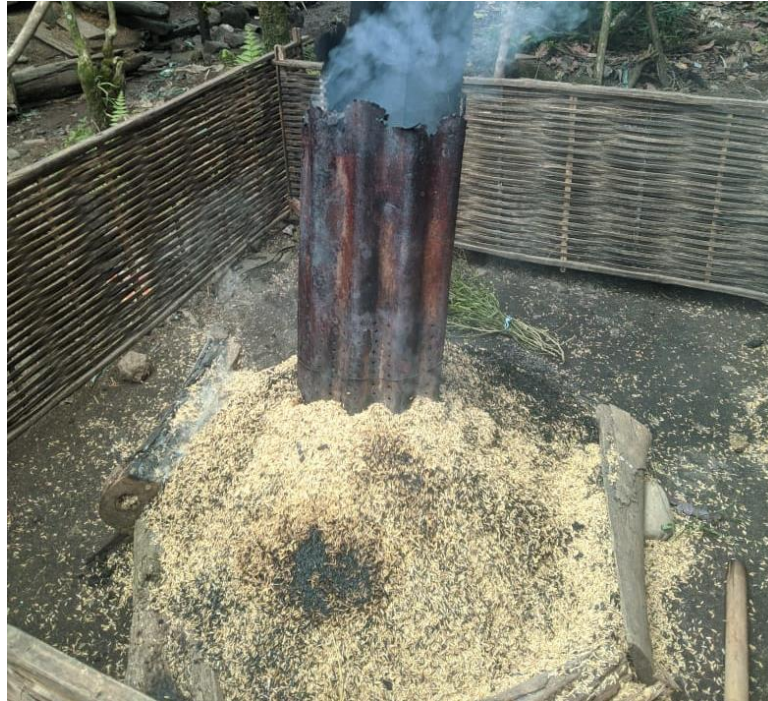
Gambar 2: Proses pembakaran sekam padi untuk menjadi biochar
