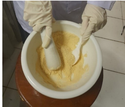
Gambar 2.10 Penghalusan bahan-bahan untuk pembuatan tablet effervescent
