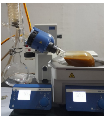
Gambar 2.8 Proses evaporasi ekstrak kulit kakao
