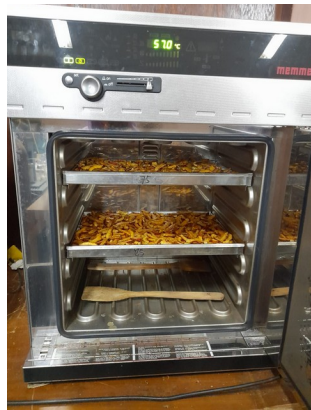
Gambar 2.4 Proses pengeringan kulit kakao menggunakan oven listrik selama 1 jam
