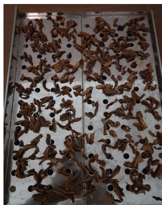
Gambar 2.4 Proses pengeringan kulit kakao menggunakan oven listrik selama 1 jam
