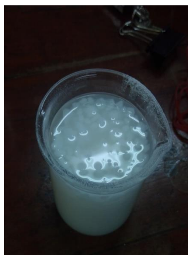
Proses pencucian polimer dengan aseton, metanol, dan akuades agar bersih dari pengotor
