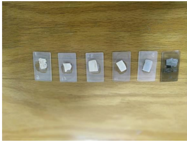
Gambar 27. Sampel Aplikasi Gigi Tiruan Yang Sudah Diuji Mekanik
