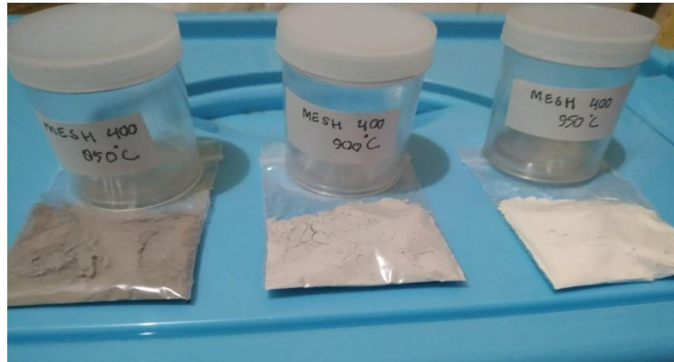
Gambar 12. Serbuk Cangkang Telur Itik Mendapat Perlakuan Kalsinasi Mesh 400
