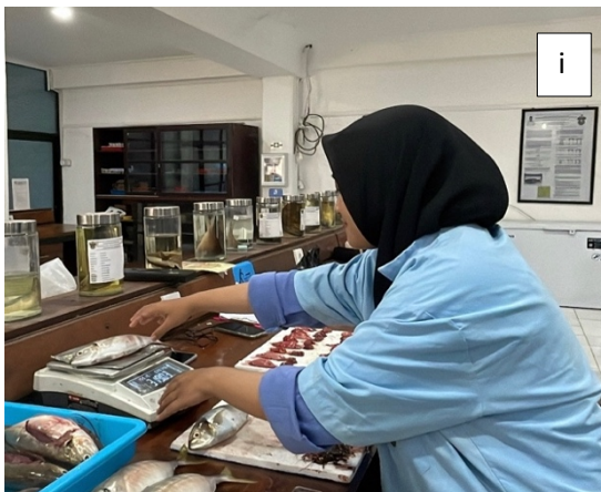
i. Sampel ditimbang menggunakan timbangan digital dengan ketelitian 0,01 g
