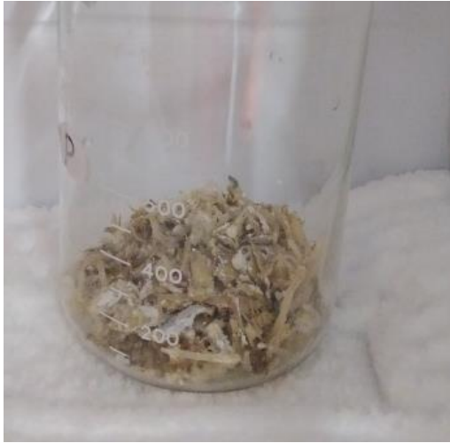
Gambar 8. Hasil filtrasi disimpan di lemari pendingin selama 24 jam kemudian dikeringkan 2-3 hari
