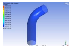
Lampiran 1. 210 Distribusi laju erosi Model Elbow Limas 4 kecepatan 6.879 m/s
