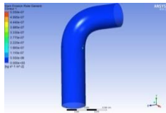
Lampiran 1. 86 Distribusi laju erosi Model Elbow Limas 3 kecepatan 2.293 m/s
