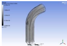
Lampiran 1. 313 Distribusi partikel fluida simulasi Vorteks Model Trapesium 1 kecepatan 13.758 m/s
