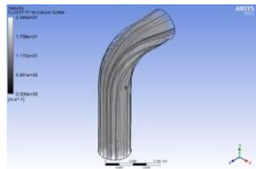
Lampiran 1. 290 Distribusi partikel fluida simulasi Vorteks Model Limas 2 kecepatan 13.758 m/s
