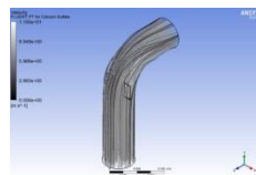
Lampiran 1. 175 Distribusi partikel fluida simulasi Vorteks Model Kotak 2 kecepatan 6.879 m/s
