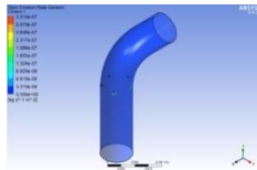
Lampiran 1. 337 Distribusi laju erosi Model Elbow Limas 8 kecepatan 13.758 m/s
