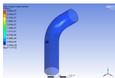
Lampiran 1. 231 Distribusi laju erosi Model Elbow Trapesium 1 kecepatan 6.879 m/s
