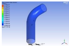
Lampiran 1. 242 Distribusi laju erosi Model Elbow Segitiga 4 kecepatan 6.879 m/s
