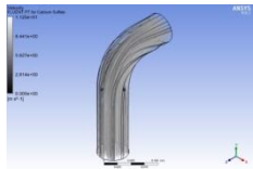
Lampiran 1. 170 Distribusi partikel fluida simulasi Vorteks Model Limas 5 kecepatan 6.879 m/s
