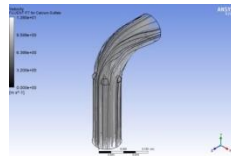
Lampiran 1. 197 Distribusi partikel fluida simulasi Vorteks Model Trapesium 8 kecepatan 6.879 m/s
