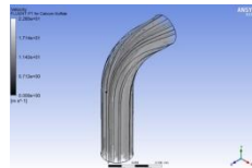
Lampiran 1. 305 Distribusi partikel fluida simulasi Vorteks Model Elips 1 kecepatan 13.758 m/s
