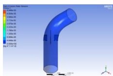
Lampiran 1. 220 Distribusi laju erosi Model Elbow Kotak 6 kecepatan 6.879 m/s
