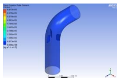
Lampiran 1. 340 Distribusi laju erosi Model Elbow Kotak 3 kecepatan 13.758 m/s
