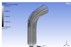
Lampiran 1. 303 Distribusi partikel fluida simulasi Vorteks Model Kotak 7 kecepatan 13.758 m/s
