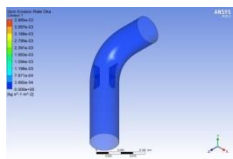
Lampiran 1. 219 Distribusi laju erosi Model Elbow Kotak 5 kecepatan 6.879 m/s
