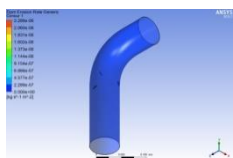
Lampiran 1. 364 Distribusi laju erosi Model Elbow Segitiga 3 kecepatan 13.758 m/s
