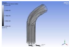
Lampiran 1. 73 Distribusi partikel fluida simulasi Vorteks Model Trapesium 7 kecepatan 2.293 m/s
