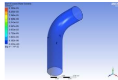
Lampiran 1. 365 Distribusi laju erosi Model Elbow Segitiga 4 kecepatan 13.758 m/s
