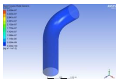
Lampiran 1. 100 Distribusi laju erosi Model Elbow Elips 1 kecepatan 2.293 m/s
