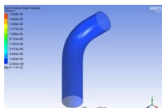
Lampiran 1. 208 Distribusi laju erosi Model Elbow Limas 2 kecepatan 6.879 m/s
