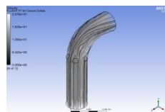
Lampiran 1. 320 Distribusi partikel fluida simulasi Vorteks Model Trapesium 8 kecepatan 13.758 m/s
