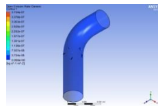
Lampiran 1. 246 Distribusi laju erosi Model Elbow Segitiga 8 kecepatan 6.879 m/s
