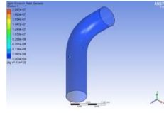
Lampiran 1. 330 Distribusi laju erosi Model Elbow Limas 1 kecepatan 13.758 m/s
