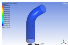
Lampiran 1. 352 Distribusi laju erosi Model Elbow Elips 7 kecepatan 13.758 m/s
