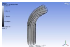
Lampiran 1. 291 Distribusi partikel fluida simulasi Vorteks Model Limas 3 kecepatan 13.758 m/s
