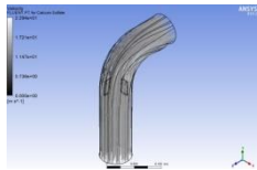
Lampiran 1. 301 Distribusi partikel fluida simulasi Vorteks Model Kotak 5 kecepatan 13.758 m/s
