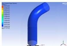
Lampiran 1. 88 Distribusi laju erosi Model Elbow Limas 5 kecepatan 2.293 m/s
