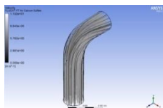
Lampiran 1. 184 Distribusi partikel fluida simulasi Vorteks Model Elips 3 kecepatan 6.879 m/s
