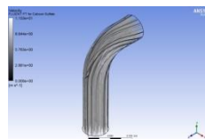
Lampiran 1. 198 Distribusi partikel fluida simulasi Vorteks Model Segitiga 1 kecepatan 6.879 m/s
