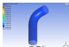
Lampiran 1. 102 Distribusi laju erosi Model Elbow Elips 3 kecepatan 2.293 m/s
