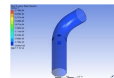
Lampiran 1. 359 Distribusi laju erosi Model Elbow Trapesium 6 kecepatan 13.758 m/s
