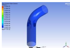
Lampiran 1. 99 Distribusi laju erosi Model Elbow Kotak 8 kecepatan 2.293 m/s
