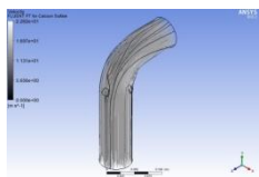
Lampiran 1. 315 Distribusi partikel fluida simulasi Vorteks Model Trapesium 3 kecepatan 13.758 m/s
