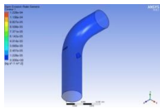
Lampiran 1. 232 Distribusi laju erosi Model Elbow Trapesium 2 kecepatan 6.879 m/s
