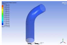
Lampiran 1. 229 Distribusi laju erosi Model Elbow Elips 7 kecepatan 6.879 m/s
