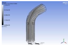
Lampiran 1. 194 Distribusi partikel fluida simulasi Vorteks Model Trapesium 5 kecepatan 6.879 m/s
