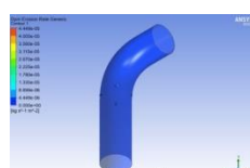
Lampiran 1. 211 Distribusi laju erosi Model Elbow Limas 5 kecepatan 6.879 m/s
