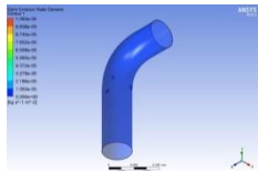
Lampiran 1. 241 Distribusi laju erosi Model Elbow Segitiga 3 kecepatan 6.879 m/s
