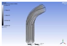
Lampiran 1. 327 Distribusi partikel fluida simulasi Vorteks Model Segitiga 7 kecepatan 13.758 m/s
