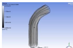
Lampiran 1. 292 Distribusi partikel fluida simulasi Vorteks Model Limas 4 kecepatan 13.758 m/s
