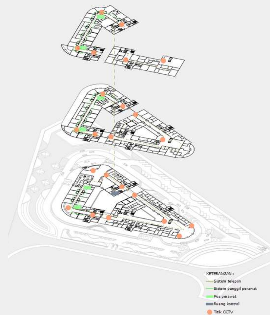
SISTEM KOMUNIKASI DAN CCTV
