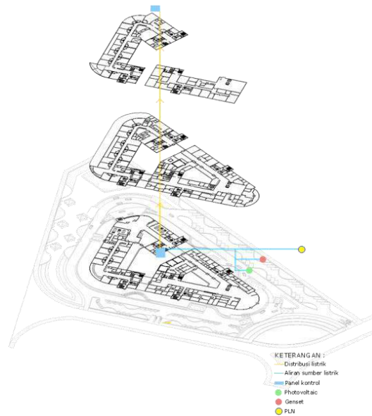
Gambar 11. Isometri sistem mekanikal elektrik
