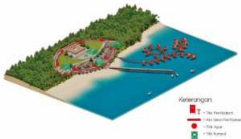
Gambar 11 Isometri sistem pencegahan kebakaran dalam tapak
