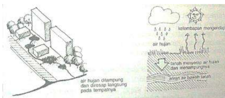
Gambar 16. Saluran Air Hujan dan Resapan Pada Tanah (Sumber: Frick, H. (2005). Arsitektur Ekologis )
