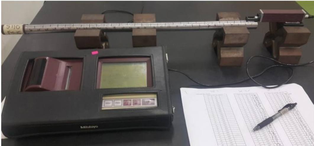
Gambar 2.5 Profilometer Kekasaran Permukaan Mitutoyo SJ-310
