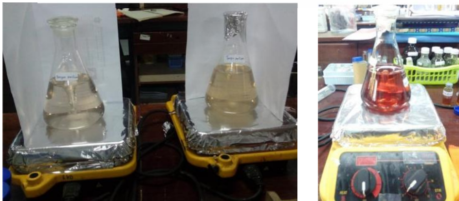
Foto 2. Sintesis nanopartikel perak dengan menggunakan magnetic stirrer
