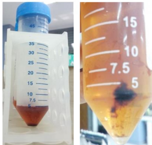
Foto 3. Hasil sentrifugasi nanopartikel perak dengan kecepatan 10000 rpm pada suhu 4°C
