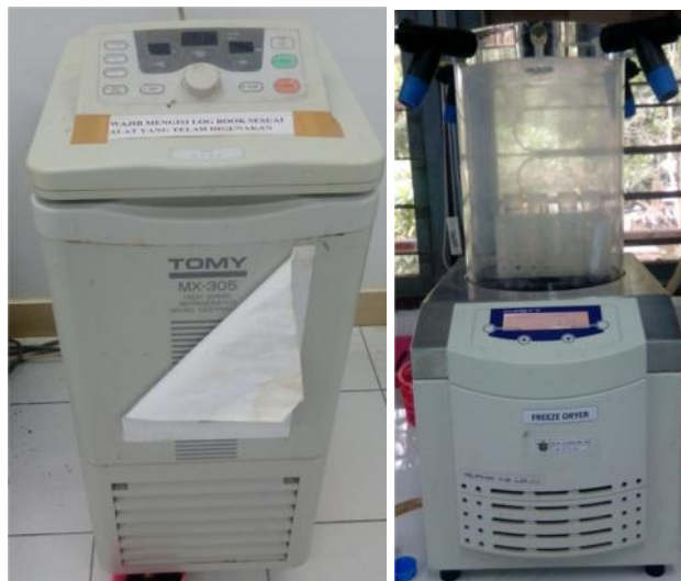
Foto 5. Alat sentrifugasi Tomi MX-305 (kiri) dan freeze dryer Alpha 1-2 LD Plus (kanan)
