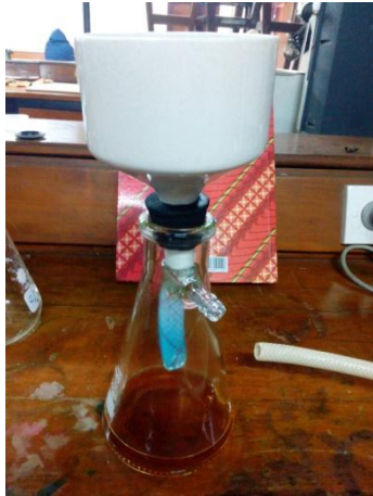
Proses penyaringan karbon aktif terdeposisi \text{MnO}_2
