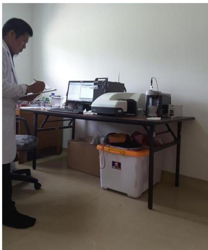
Gambar 38. Analisa ukuran dan distribusi ukuran partikel menggunakan Particle Size Analyzer
