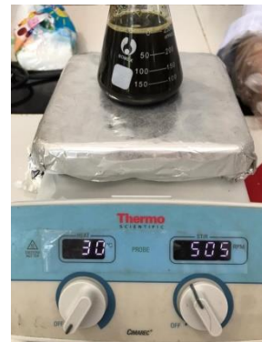
Pencampuran dengan larutan methanol selama 3 jam, lalu di stir (aduk) selama 6 jam.
