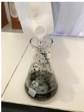
Pencampuran dengan larutan methanol selama 3 jam, lalu di stir (aduk) selama 6 jam.
