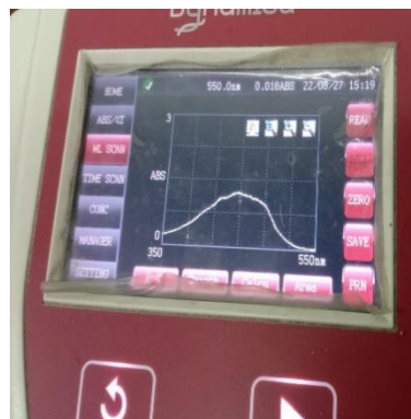
Gambar 31. Pengukuran dengan spektrofotometri UV-Vis
