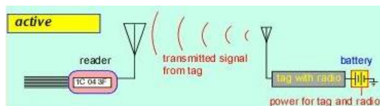
Gambar 4 Cara kerja RFID tag aktif
