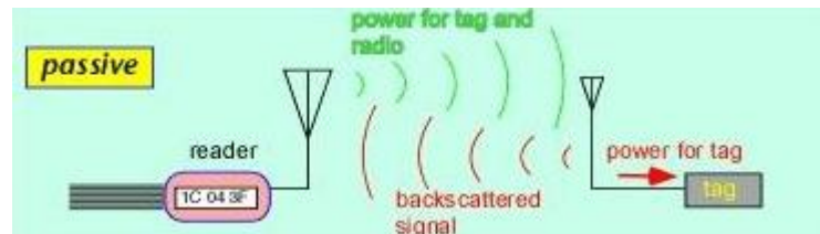
Gambar 3 Cara kerja RFID tag pasif
