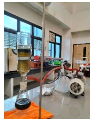
Gambar 11. Fraksinasi dengan metode Kromatografi Cair Vakum (KCV)
