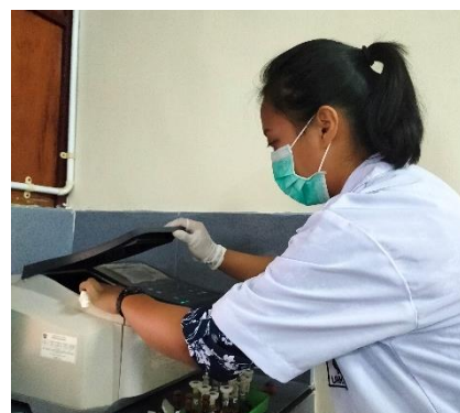
Gambar 13. Pengujian nilai persen inhibisi menggunakan spektrofotometer UV-Vis
