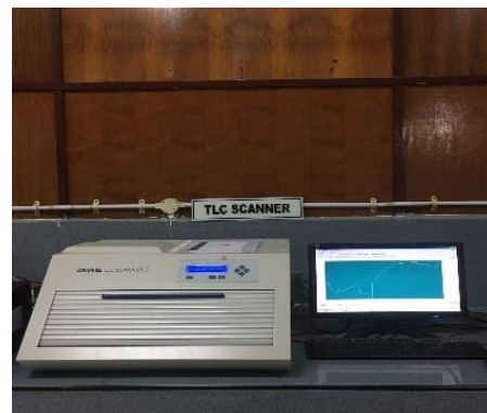
Gambar 28. Analisis Lempeng KLT dengan Alat TLC Scanner
