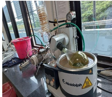
Gambar 20. Pemekatan Sampel menggunakan Rotary evaporator
