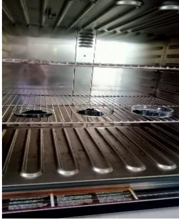
Gambar 17. Dilakukan uji kadar air dengan oven suhu 105^{\circ}\text{C} selama 3 jam
