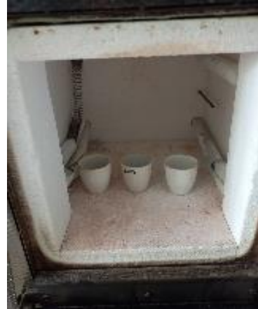
Gambar 18. Dilakukan uji kadar abu dengan tanur suhu 550^{\circ}\text{C} selama 8 jam
