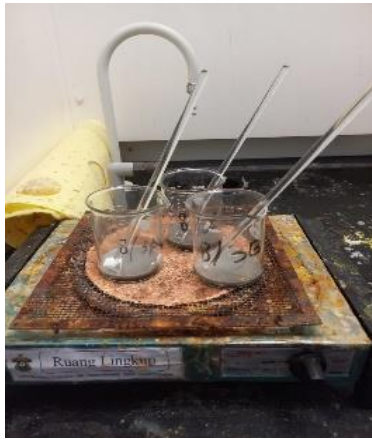
Gambar 19. Proses destruksi basah menggunakan \text{HNO}_3 67% dan \text{H}_2\text{O}_2 30%
