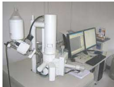
Gambar 3.7 Alat uji SEM
