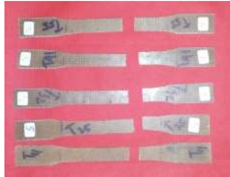
Gambar 4.2 Spesimen Komposit Tenun Rami Hasil Uji Tarik
