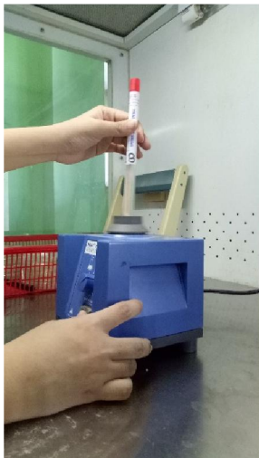
Melakukan prosedur vortex untuk menghomogenkan
