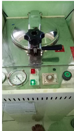
Sterilisasi medium PCA pada autoclave
