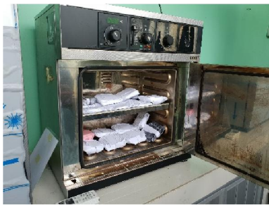
Membungkus cawan petri dengan kertas dan memasukkan dalam inkubator selama 24 jam
