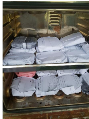
Membungkus cawan petri dengan kertas dan memasukkan dalam inkubator selama 24 jam
