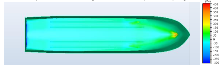
Visualisasi static pressure model kapal menggunakan vortex generator Kecepatan 1,513 dengan trim 1° tampak bawah
