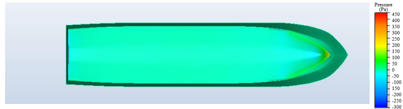
Visualisasi static pressure model kapal tanpa menggunakan vortex generator kecepatan 0,75 m/s dengan kondisi 0° tampak bawah
