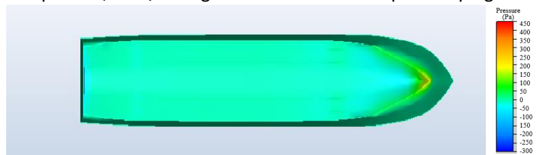
Visualisasi static pressure model kapal menggunakan vortex generator kecepatan 0,75 m/s dengan kondisi trim 0° tampak bawah
