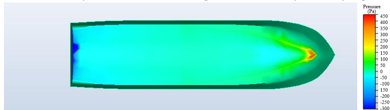
Visualisasi static pressure model kapal tanpa menggunakan vortex generator kecepatan 1,513 m/s dengan trim 1° tampak bawah
