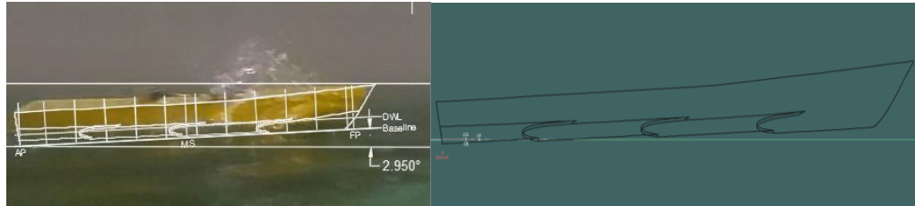
Kondisi Trim 2.950 Derajat Model Kapal Deadrise Angle 15 Derajat Dengan 3 Stepped 2U Dengan Kecepatan 3.012 m/s.
