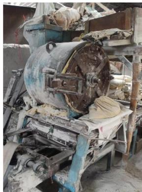
Gambar 11. Mesin Penggiling Limbah Kaca
